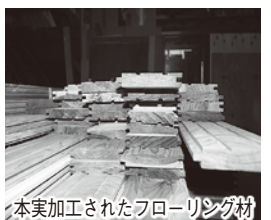
本実加工されたフローリング材
